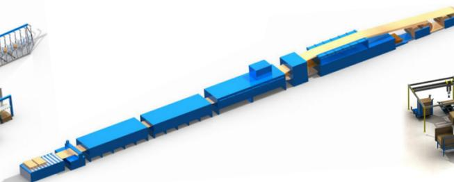
**5** Линия производства ячеистого (сотового) картона
